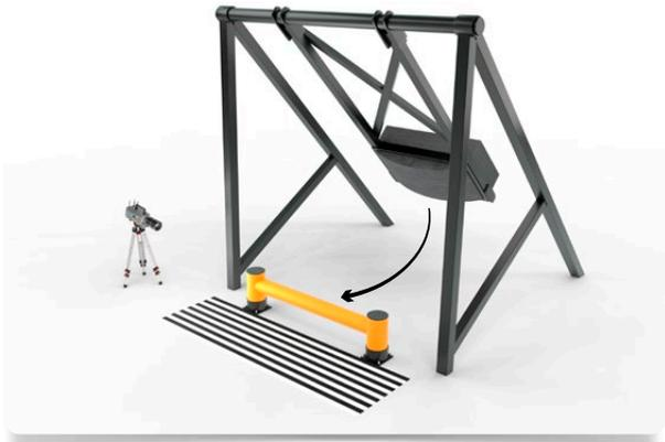
Fig. 1 - Il braccio oscillante forma un angolo di 90 gradi con la protezione.
