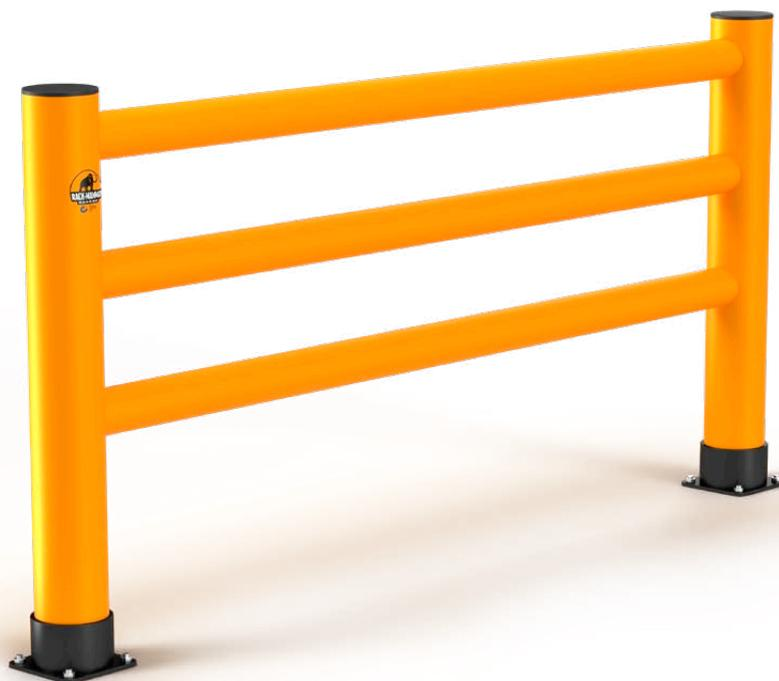
La barriera Rack Pedestrian Barrier viene utilizzata per segnalare visivamente i percorsi. Protegge i pedoni e i conducenti dei veicoli in caso di incidente, assorbendo e dissipando l'energia dell'impatto.
